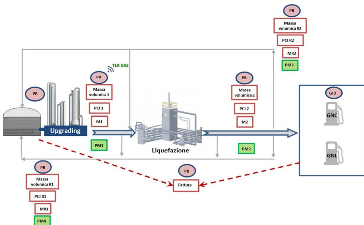
Figura 13 – Schema dei punti di misura e delle grandezze rilevanti ai fini del calcolo della quantità ammessa all'incentivo nel caso di immissione in consumo del biometano in forma liquida (BML) tramite connessione diretta all'impianto di liquefazione e a quello di distribuzione, senza ritiro del biometano da parte del GSE.
