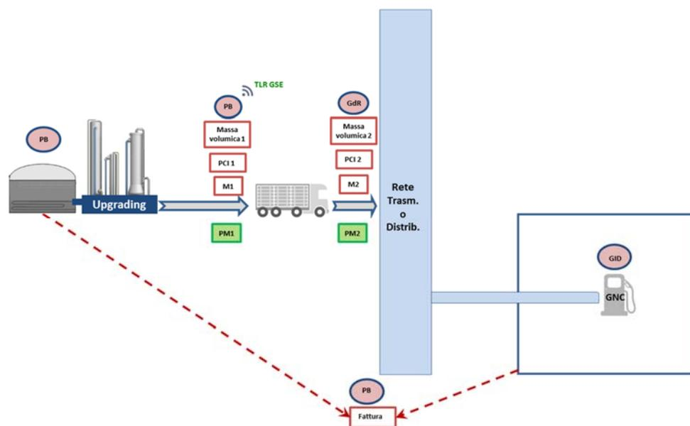
Figura 8 – Schema dei punti di misura e delle grandezze rilevanti ai fini del calcolo della quantità ammessa all’incentivo nel caso di immissione in consumo nei trasporti mediante rete con obbligo di connessione di terzi collegata all’impianto di produzione tramite carri bombolai, senza il ritiro del biometano.
