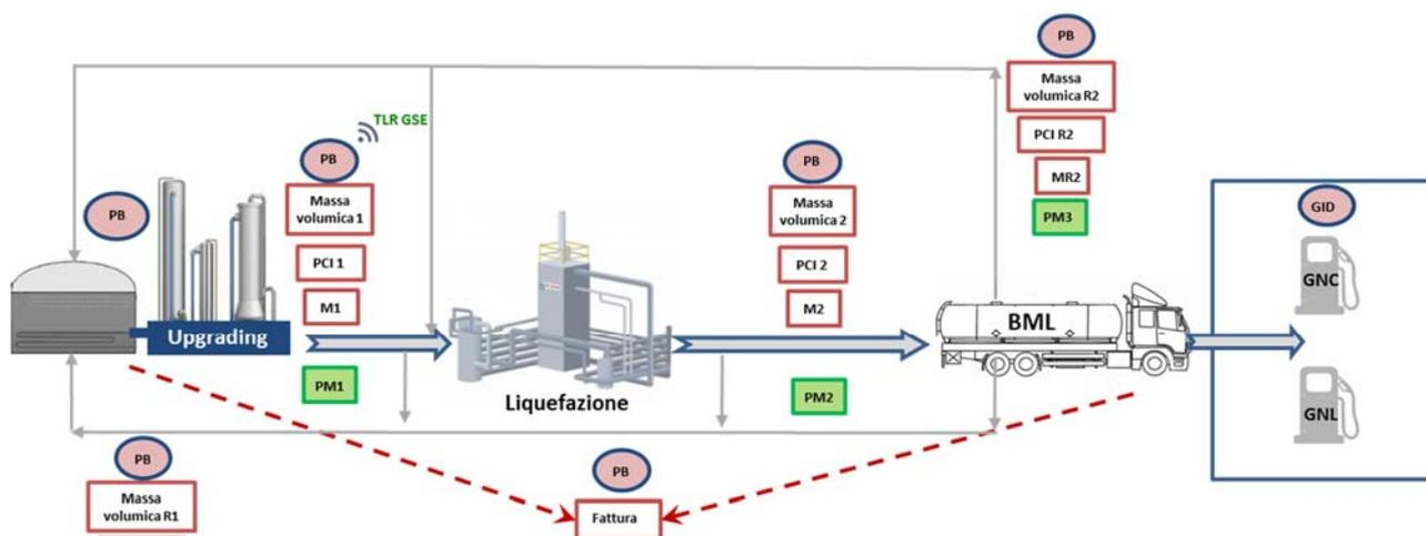
Figura 11 – Schema dei punti di misura e delle grandezze rilevanti ai fini del calcolo della quantità ammessa all'incentivo nel caso di immissione in consumo nei trasporti mediante il trasporto del biometano in forma liquida (BML) e connessione diretta all'impianto di liquefazione, senza ritiro del biometano.
